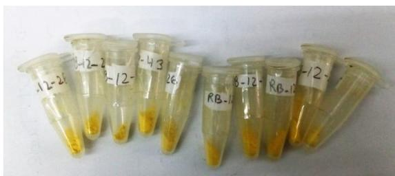
**Fig. 22** muestras de feldespato potásico teñidas y molidas en tubos Eppendor
