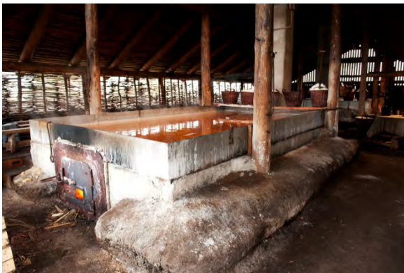
Figura 7: Producción de sal en las grandes dorias de acero inoxidable.
