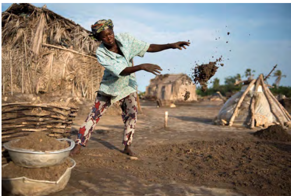
Figura 9: Dos o tres días después de echarla al campo, la arena volverá a estar salada y se repetirá el ciclo de recogida y filtrado
