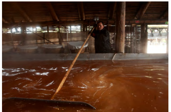
Figura 8: La salmuera ha de ser agitada para evitar que se adhiera al fondo de la doria.
