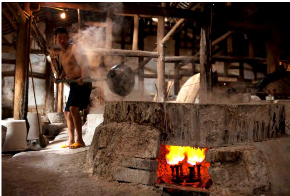
Figura 7: El gas extraído sirve para calentar la salmuera
