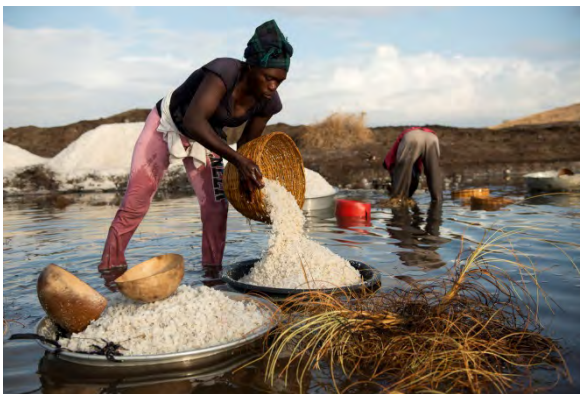
Figura 7: La sal se extrae del fondo de las eras con cascaras de coco.
