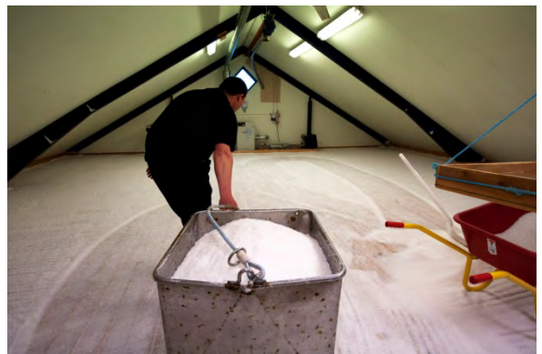
Figura 10: La sal se extiende para completar el secado y para proceder a su limpieza.
