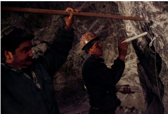
Figura 7: Perforación de la roca e introducción de dinamita
