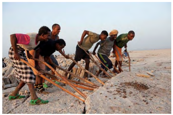
Figura 6: El equipo emplea palos como palancas para extraer bloques irregulares de sal.
