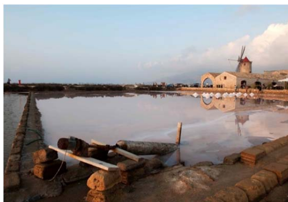
Figura 27. Tornillo de Arquímedes utilizado para el bombeo de salmuera en Salina Culcas, Trapani, Sicilia. Al fondo, molino tradicional utilizado para la molienda de la sal.
