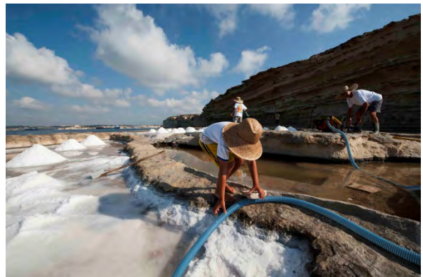
Figura 8: Bombeo de sal desde los pozos concentradores a las eras
