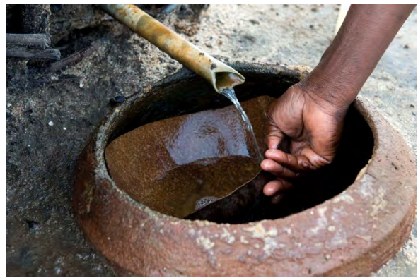
Figura 8: La salmuera resulta de filtrar con agua la arena cosechada
