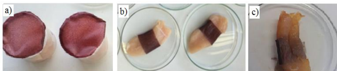
Figura 39. Fotografias evidenciando a aplicação das embalagens nos pedaços de frango de maneira (a) indireta (pedaço de frango na parte interna do béquer), (b) direta (o filme foi diretamente enrolado no pedaço de frango) e (c) aspecto visual dos filmes de amido de mandioca (4%) e resíduo de mirtilo após 10 dias de contato, mantidos na temperatura de refrigeração de 6\text{ }^{\circ}\text{C} .
