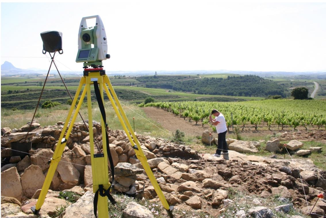
Fig. 8.- Medida de puntos mediante métodos topográficos (estación total y prisma).
