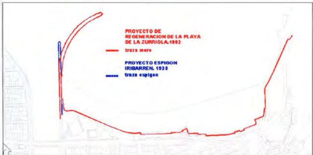
Si comparamos el proyecto de Iribarren con el que posteriormente se construyó en 1996, parece razonable dudar de la efectividad que hubiera tenido el espigon proyectado por Iribarren en el proceso de formación de la playa, que sin duda debía ser de mayor longitud.
