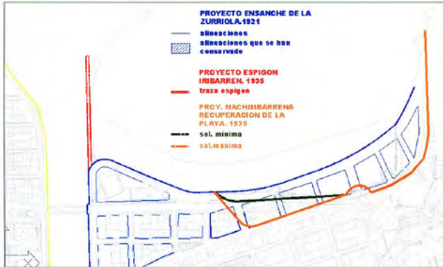
Se puede comprobar que la solución propuesta por Iribarren era menos traumática que las de Machimbarrena. Sin embargo, no se tuvieron en cuenta las dificultades que podrían presentarse durante su construcción en un periodo de penuria como fue el de postguerra.
