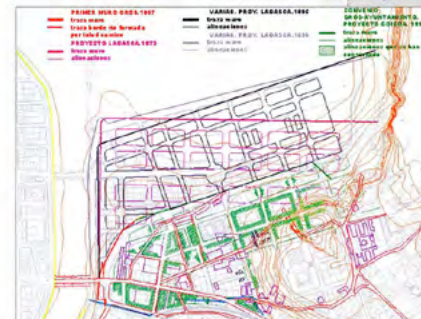
Comparación de los proyectos de Lagasca de 1873, la variación propuesta por la Sociedad Inmobiliaria en 1895 y el proyecto de Sarasola, cuya primera redacción data de 1901. Como se ve es la misma idea, modificada para cumplir las condiciones impuestas por la Junta Consultiva estrechando el cauce del río, para dar anchura uniforme y abocinando la desembocadura.
