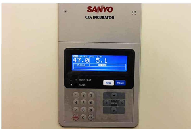
Figura 75. Imagen del panel de control del incubador de CO 2 empleado para los procedimientos de HT in vitro, con la temperatura determinada a 47° C.
