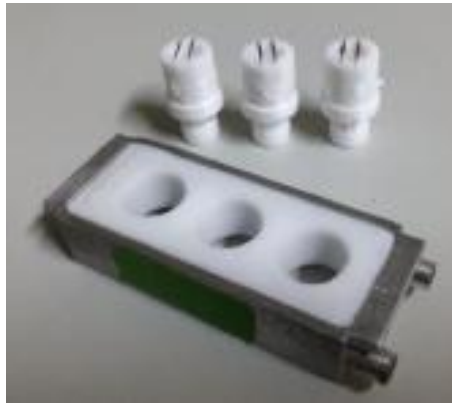
2.4 Irudia. Platinozko hari batera itsatsitako GUVak prestatzeko erabiltzen den etxeke ganbera eta politetrafluoroetilenozko (PTFE) putzu zirkularrak.
