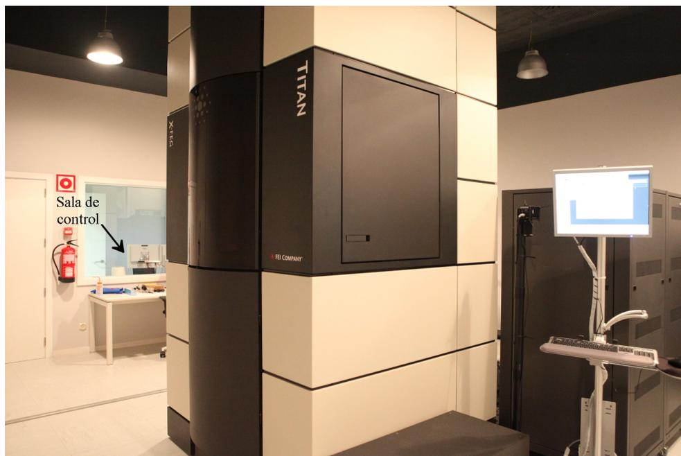
Figura 3.10 Microscopio electrónico de transmisión FEI Titan Cubed G2 60-300 ubicado en el área de servicios generales SGiker de microscopía electrónica y microanálisis de materiales de la Universidad del País Vasco.
