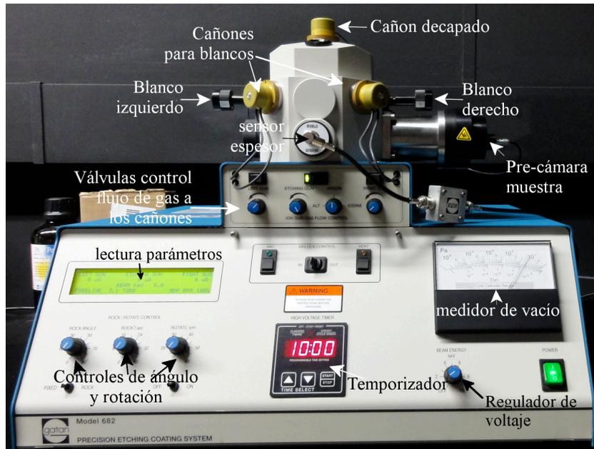
Figura A-1.1 Equipo PECS™ 682 utilizado en el decapado por bombardeo iónico de las muestras estudiadas.
