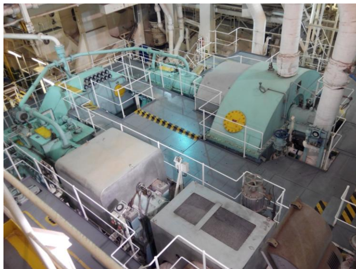
Figura 4: Turbina de alta y baja presión, turbina de ciar y reductora. Fuente: propia
