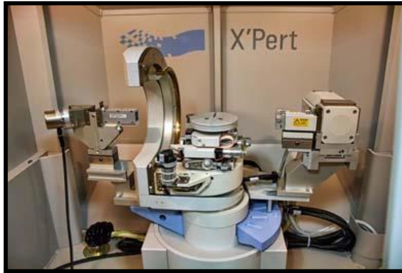
Figura 5. Difractor de rayos X UPV.
