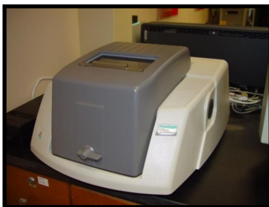
Figura 18. FTIR Omnic Avatar ThermoNicolet utilizado en esta investigación.
