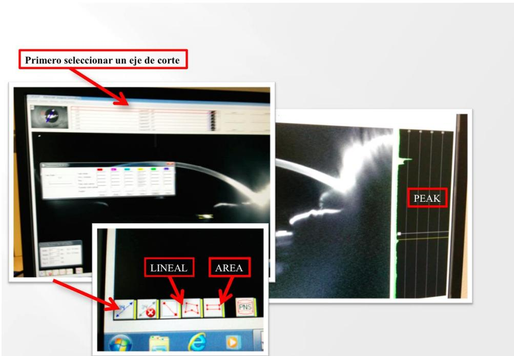
**Figura 12.** Tras seleccionar un meridiano a estudio seleccionamos herramienta de medida de densimetría que queramos analizar (área o lineal).
