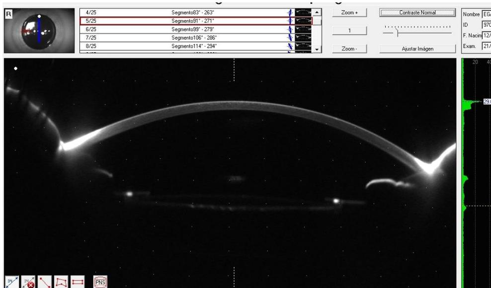
**Figura 11.** A continuación elegimos el meridiano a estudiar, en este caso 90°. En la imagen en posición inferior izquierda, se aprecian por este orden, las herramientas de medida: la herramienta para densitometría lineal (3º posición), densitometría área (quinta posición) y el último el PNS para medir densidad del núcleo de cristalino para medición del grado de catarata
