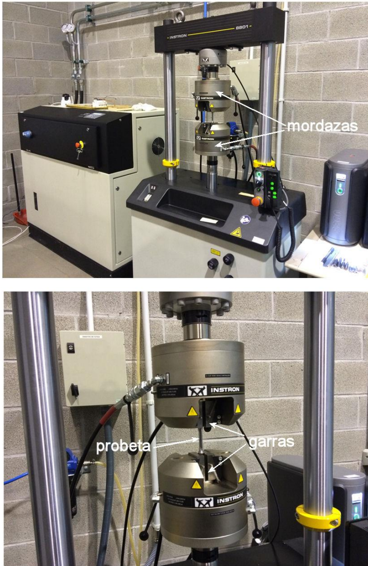
Figura 11-3. Máquina de ensayos axiales Instron 8805 MTB (Laboratorio del Dpt. I. Mecánica en la ETSI de Bilbao) y detalle de la sujeción de las probetas.
