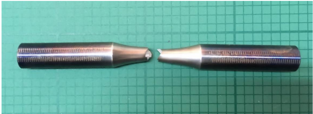
Figura 11-4. Probetas rotas en la máquina axial Instron 8805 MTB, arriba: Rotura por el hombro debido al defecto de diseño de las mordazas, abajo: Rotura correcta en la zona central.
