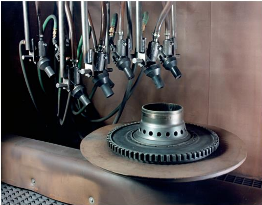
Figura 3-5. Máquina de granallado por aire (imagen de Progressive Surface™) http://www.progressivesurface.com/zoommachine.php?id=71
