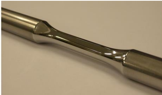
Figura 6-18. Probeta pulida y repasada hasta acabado a espejo con “sand grit paper” de grado P4000
