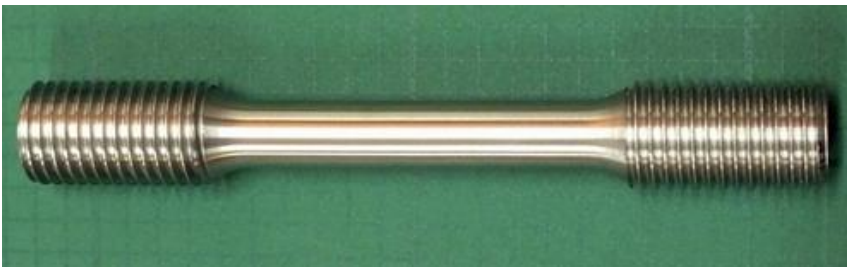
Figura 6-4. a. Dimensiones de la probeta de tracción según norma UNE-EN ISO 6892-1, b. foto probeta.
