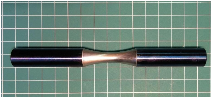
Figura 6-9. a. Dimensiones de las probetas “Hourglass” utilizadas en los ensayos axiales en la máquina Instron 8805 MTB. b. Foto de una probeta para tensión directa en la máquina Instron antes de ser pulida.
