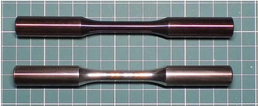
Figura 7-3. Probeta al salir del horno y una vez pulida a mano.
