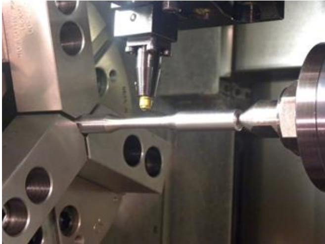
Figura 3-18. Instalación para LPB de probetas cilíndricas 1
