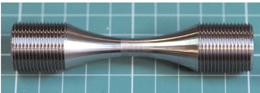
Figura 6-11. foto de probeta para tensión directa en MTS (antes de SP).
