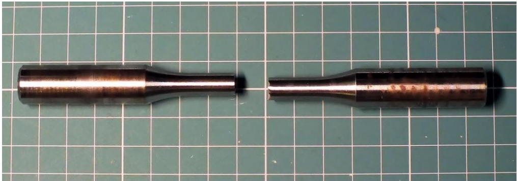
Figura 11-2. Típica rotura de una probeta de acero 34CrNiMo6 templado y revenido en la máquina Zwick-Roell.
