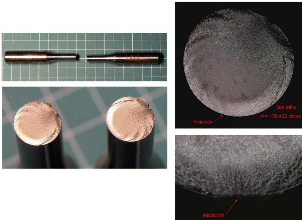
Figura 11-6. Probeta de acero 34CrNiMo6 mecanizada rota, y detalle de la sección
