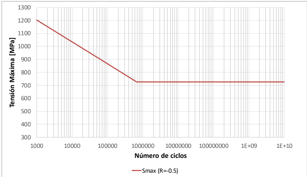
Figura 10-4. Curva de fatiga para ensayo axial ( R=0.5 ) en probeta pulida
