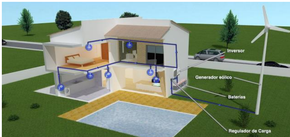
Ilustración 16: Instalación de minieólica
