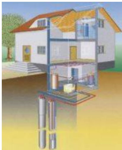
Ilustración 4: Sondeo vertical geotérmico
