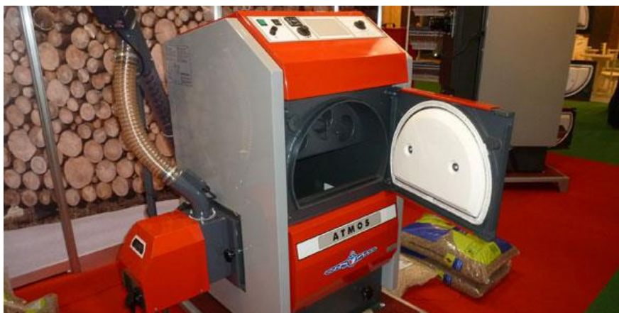
Ilustración 9: Caldera de Biomasa alimentada por PELLETS
