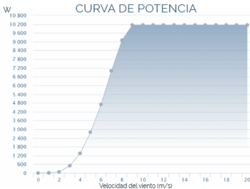
Ilustración 20: Curva de potencia de un aerogenerador AENAIR E200
