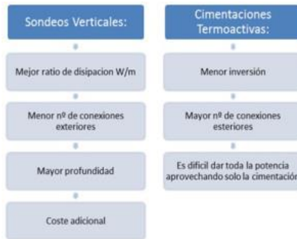
Ilustración 8: Diferencias entre sondeo vertical y cimentaciones termoactivas
