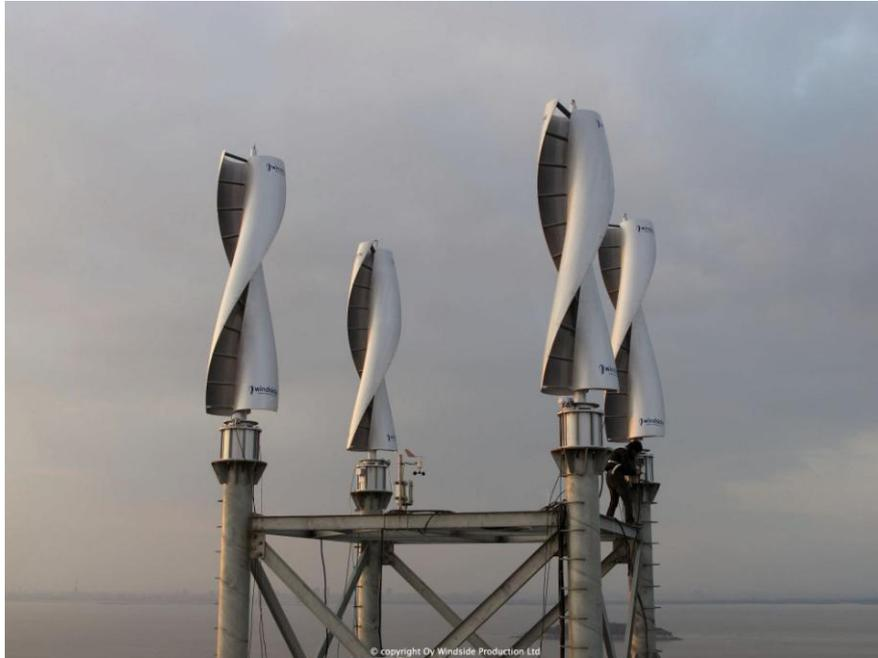
Figura 7 Aerogenerador Savonius
