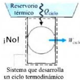
Ilustración 9. Formulación de Kelvin-Planck del segundo principio. Fuente<sup>[9]</sup>
