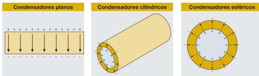
Ilustración 11. Condensador planos-cilíndricos-esféricos
