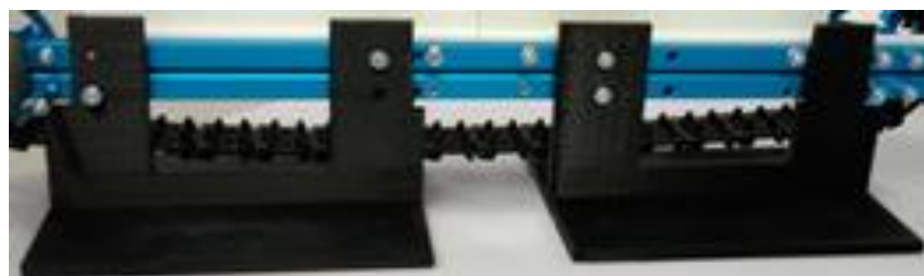
Irudia. 26. Uhal garraiatzailearen euskarri piezak
