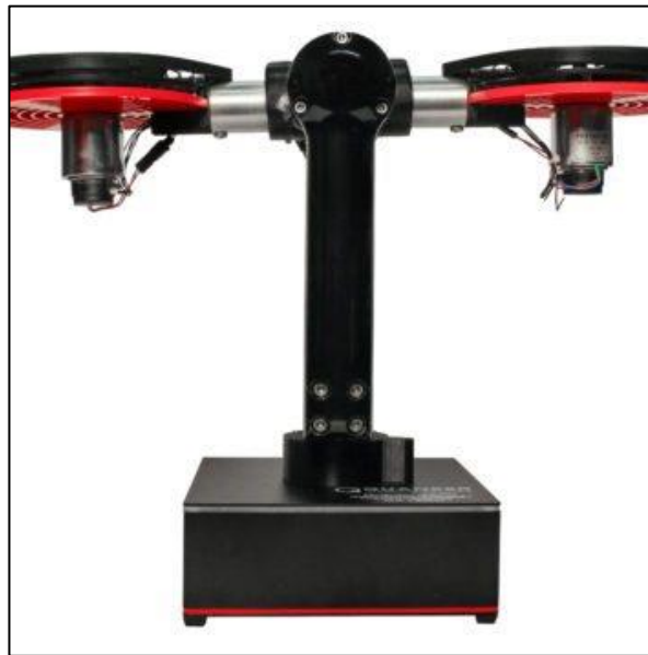
3.3. Irudia: Quanser AERO malda kontrolako konfigurazioan [9]
