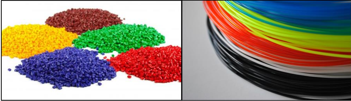
5.1. Irudia: ABS materiala pikorretan (ezkerrean)[15] eta filamentuetan (eskuinean)[16]
