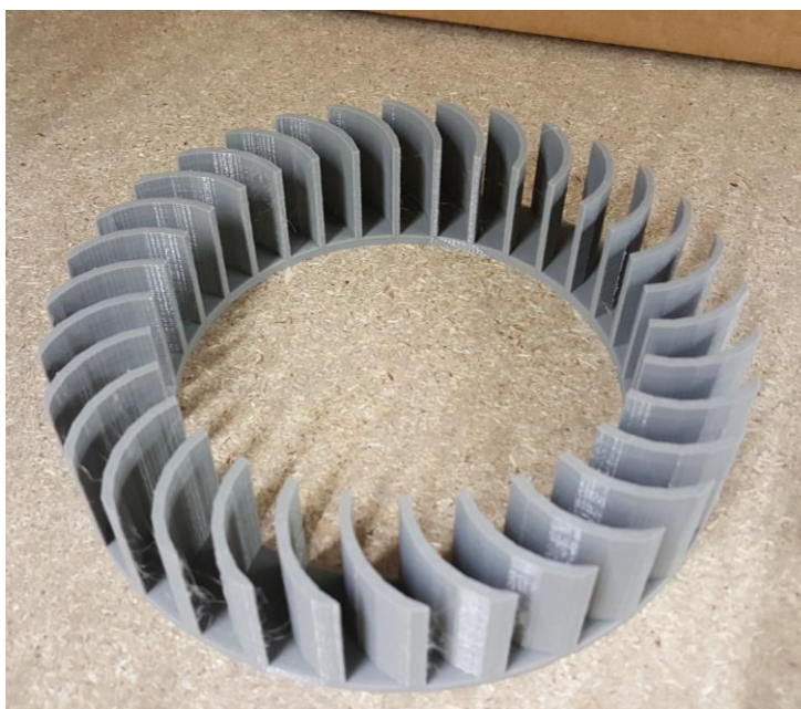
Figura 70: Corona y álabes del rodete impreso en 3D
