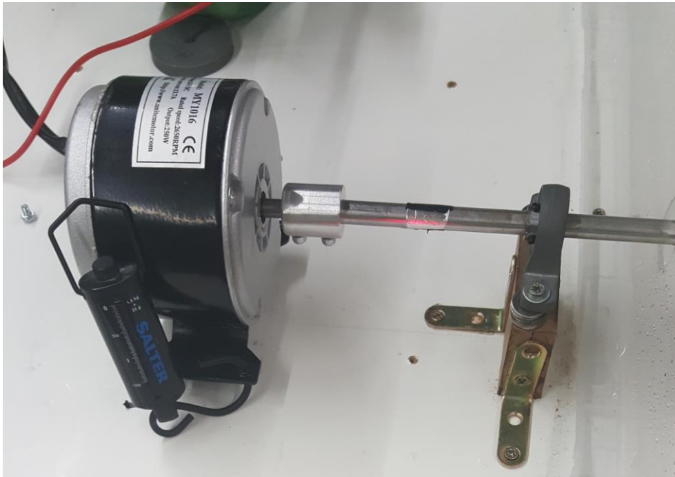
Figura 77: Motor de corriente continua y acoplamiento
