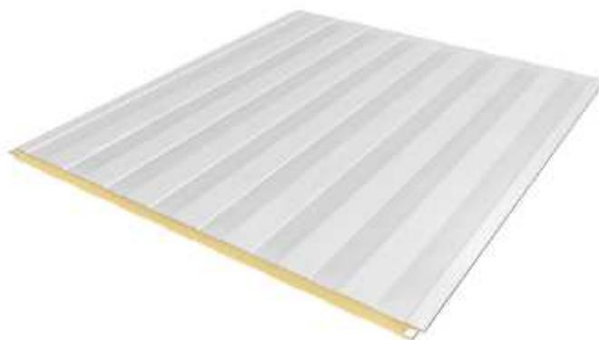
Nuestras líneas de fabricación de panel de poliuretano, conforman el panel con dos caras metálicas y en un proceso continuo de fabricación, inyectan el aislamiento con espumas PUR y PIR, con una densidad de  $40\text{kg/m}^3$ .
