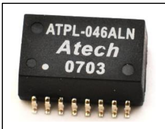
Figura 6.13. Transformador Ethernet Atech ATPL-046 (CDR, 2018)
