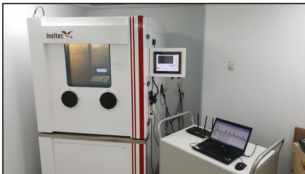
Figura 9.2. Cámara climática con la balanza en el interior, punto de acceso y PC
