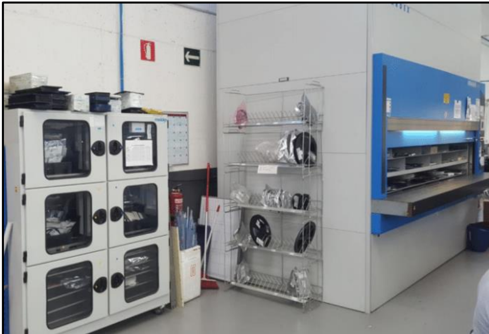
Figura 8.46. A la izquierda las cámaras de control y a la derecha la estantería robotizada.
