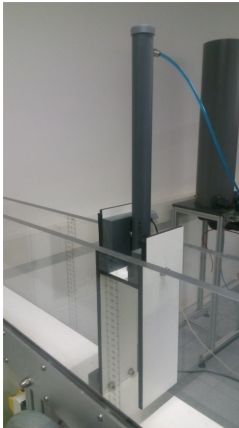
Figura 4.7: Fotografía de la chimenea, con el diafragma y la toma de presión
