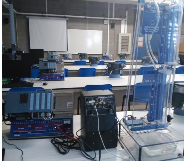
Ilustración 11. PLC SIMATIC s7-1500 y maqueta.
