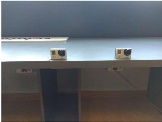
**Figura 11: Disposición de las cámaras. Colocadas en una mesa plana de forma que sus ejes queden paralelos.**
