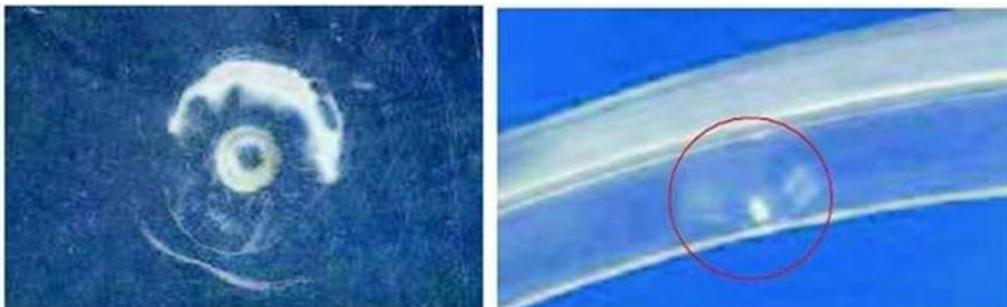
**Figura 11 Marcas de los puntos de inyección**
