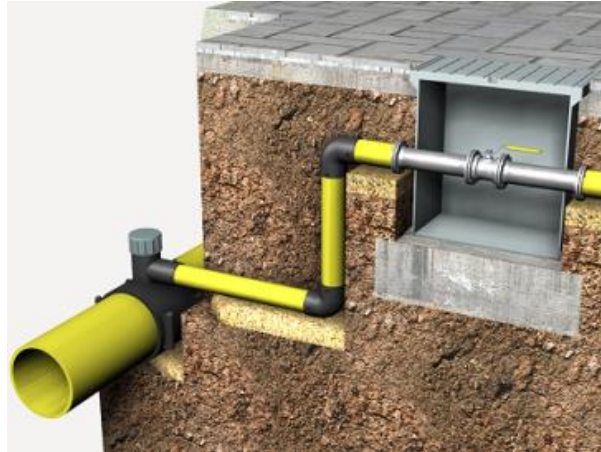
Figura 96: Acometida particular (Construmatica)
