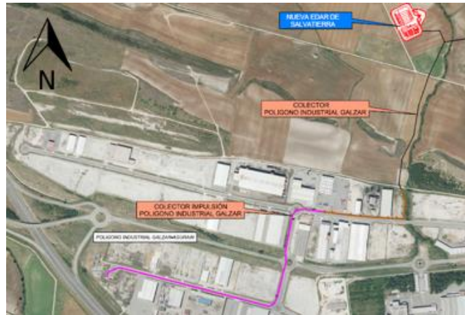
Figura 2: Conexión EDAR Industrial-Nueva (Saitec, 2017)
