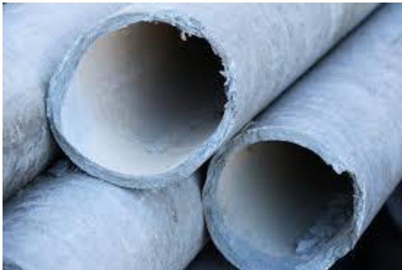
Figura 2: Tuberías de fibrocemento (Google)
