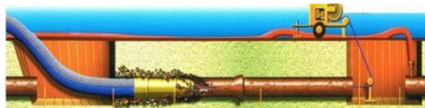
Figura 93: Colocación de tubería siguiendo el método de fractura de tubería
