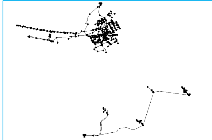
Figura 4: Esquema de la red con los concejos funcionando independientemente y con su depósito (EPANET)
