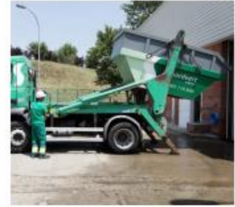
Carga de residuos con camión portacontenedores.
