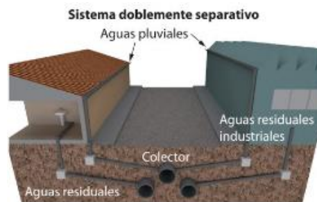
Figura 103: Sistema doblemente separativo (PR Ejea SL, Consultado en 2018)
