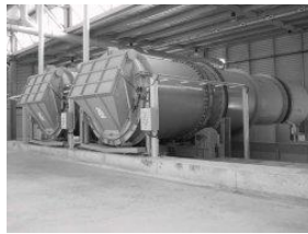
Figura 116: Sistema cerrado de compostaje (Google)
