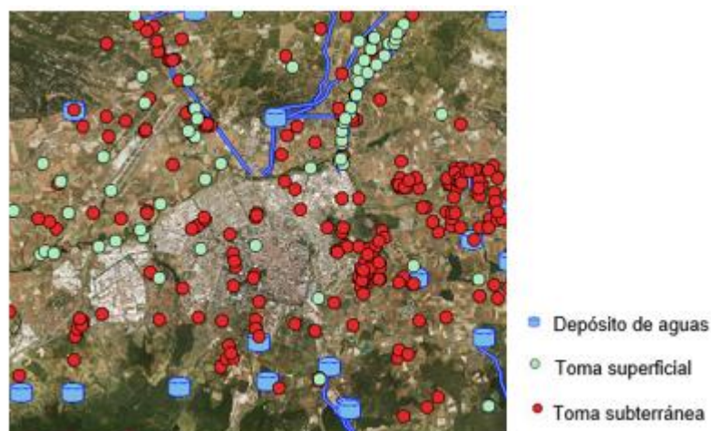
Figura 44: Infraestructura hidráulica en el entorno de una ciudad moderna. Caso de Vitoria-Gasteiz. Depósitos, conducciones y tomas (Redes DFA)
