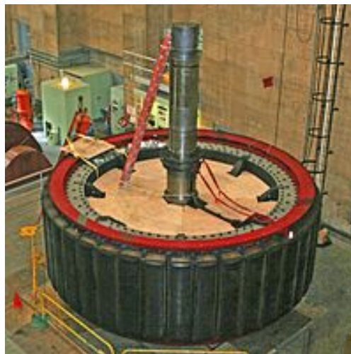
Ilustración 16. Rotor o inductor de un generador de gran potencia
