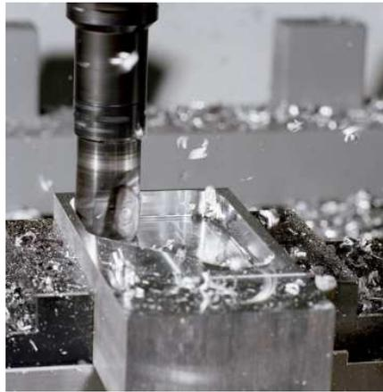
**Ilustración 22. Fresa mecanizando pieza metálica**
