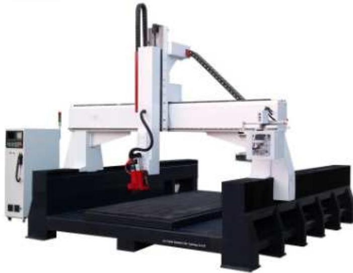
**Ilustración 23. Máquina herramienta CNC de 5 ejes. Cortesía de Chaoda**
