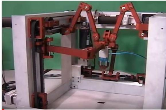
Ilustración 14. Manipulador Quadrupteron, 4 GDL
