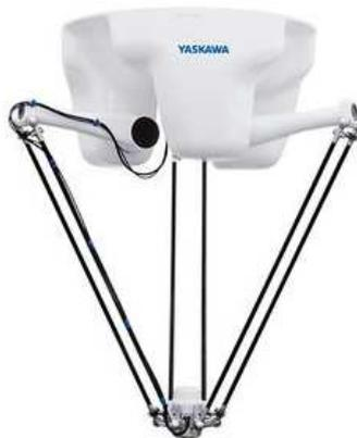
**Ilustración 5. Robot Delta para industria alimenticia, 4 GDL. Cortesía de Yasakawa**
