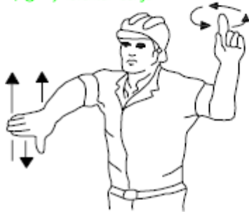
10 Bajar el aguilón o pluma y levantar carga
