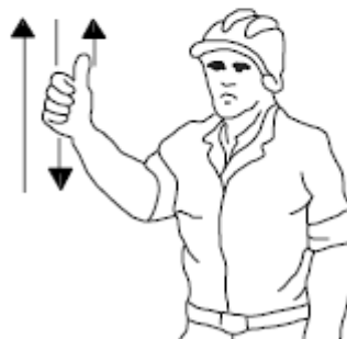
4 Levantar el aguilón o pluma lentamente
