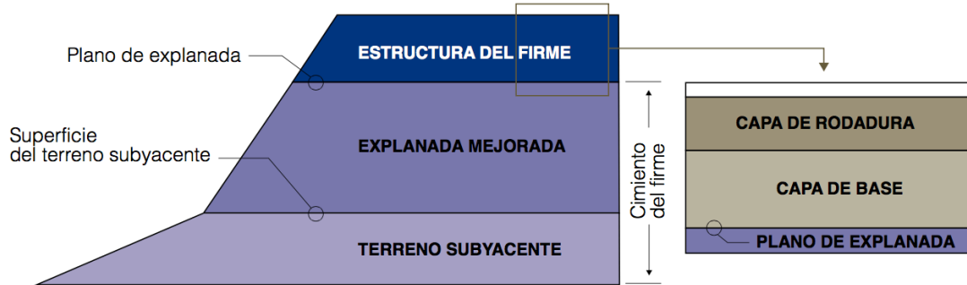
Figura 13. Esquema de composición de las estructuras de firme y explanada (Fuente: Recomendaciones para el diseño de firmes de vías ciclistas del Gobierno Vasco)
