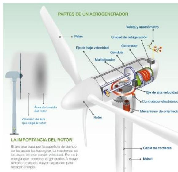
**Ilustración 13: Componentes de un aerogenerador.**
