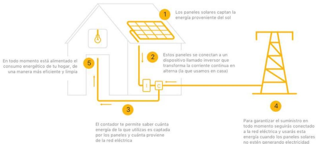
**Ilustración 25: Esquema instalación fotovoltaica.**
