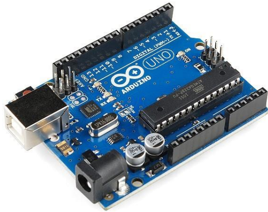
Figura 12: Arduino UNO R3
