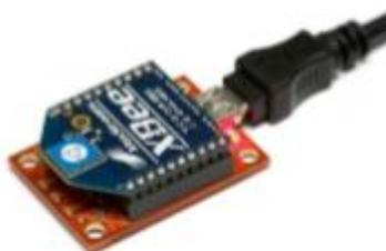
*Figura 4.3.2. Conexión del módulo Xbee al Explorer USB*
