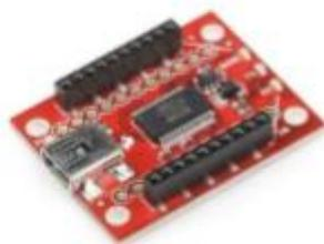
*Figura 4.3.1. Xbee Explorer USB*
