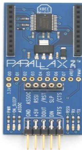
*Figura 4.4.1. USB XBee SIP Adapter*
