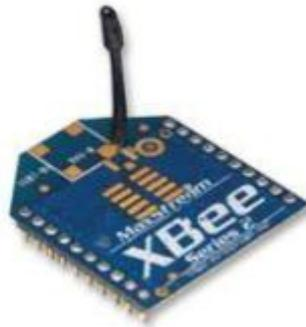
*Figura 4.2.1. Módulo Xbee ZNet 2.5 RF Series2 de Digi*
