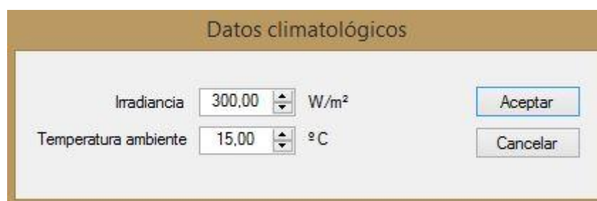
Figura 31: Introducción manual de las condiciones ambientales
