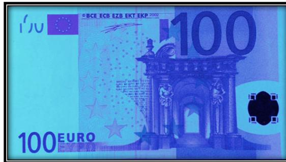
**Figura 15.** Evidencia dubitada bajo luz ultravioleta. Se observa que carece de fibrillas de seguridad.
