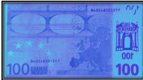
**Figura 17.** Evidencia dubitada bajo luz ultravioleta. Carece de tinta con respuesta óptica.
