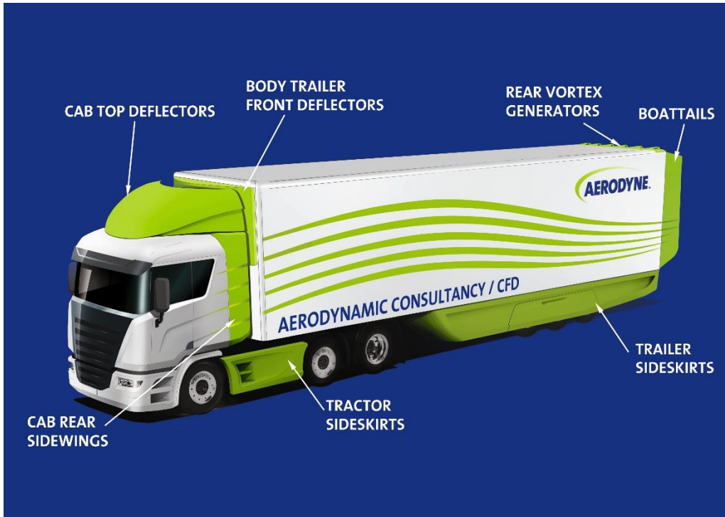
Ilustración 4. Mejoras aerodinámicas en trailers europeos
