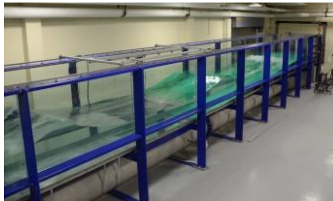
Ilustración 13: Canal de olas instalado y construido por Edinburgh Designs [15]
