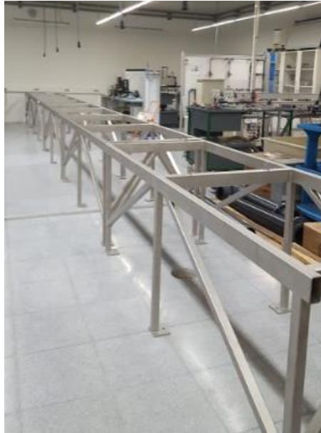
Ilustración 41: Estructura del canal
