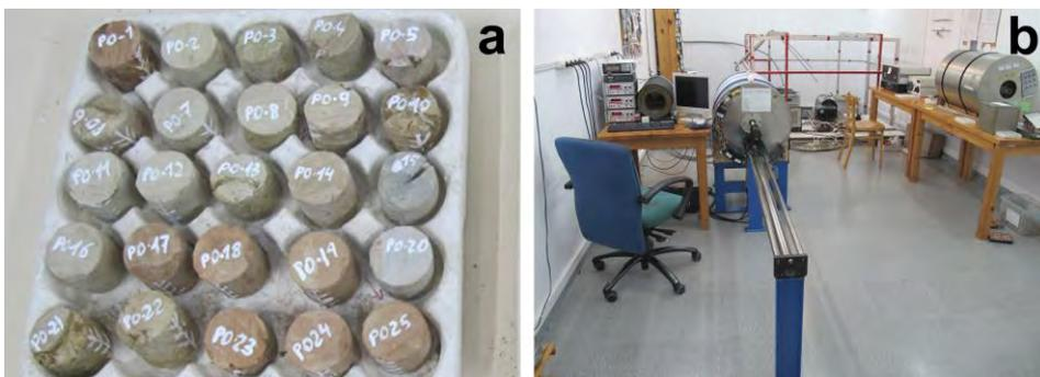
**Figura 4.10. a:** Muestras cortadas, consolidadas y sigladas. **b:** Magnetómetro criogénico.
