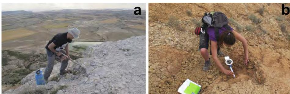
**Figura 4.9. a:** Toma de muestra con el taladro. **b:** Orientación de la muestra con la brújula.
