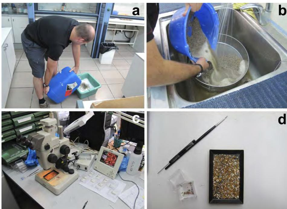
**Figura 4.3.** Técnicas de laboratorio. **a:** Tratamiento con ácido acético. **b:** Lavado de sedimento en el laboratorio. **c-d:** Triado con la lupa binocular.
