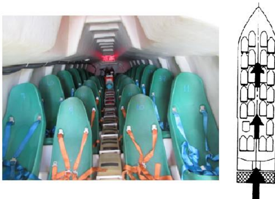
Figura 9: Interior de un bote de caída libre y procedimientos de embarque [24]
