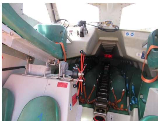
Figura 11: Orientación de los asientos de un bote de caída libre [Figura propia]
