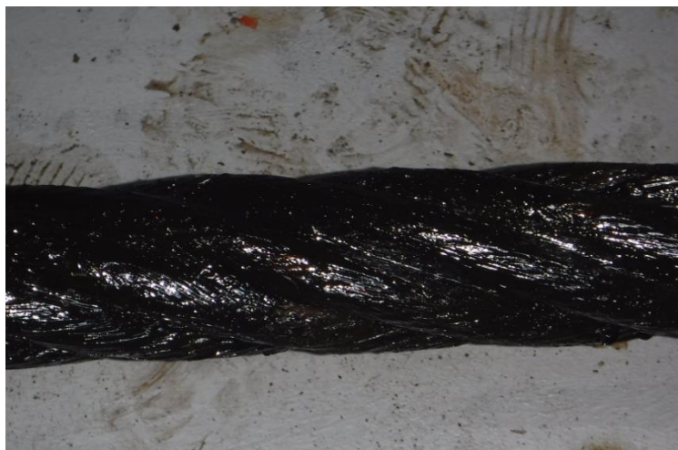
Figura 42: Alambre bien engrasado, para su prevención de la oxidación [Figura propia]
