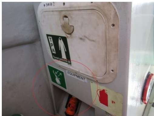
Figura 21: SART estibado en el interior del bote y su símbolo [Figura propia]
