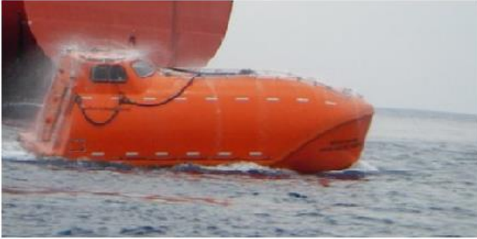
Figura 23: Sistema de dispersión de agua de protección contra el fuego [24]
