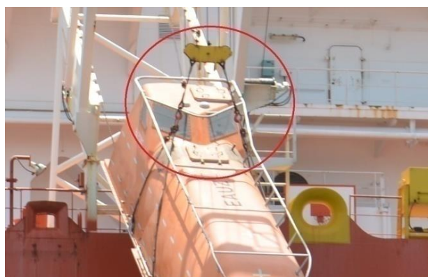
Figura 35: Punto de unión de las trincas y el gancho del pescante en un bote de caída libre [Figura propia]
