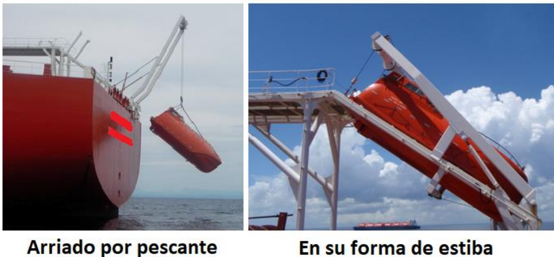
Figura 10: Bote de caída libre (FFLB) en posición de estiba y arriado por pescante [Figura propia]
