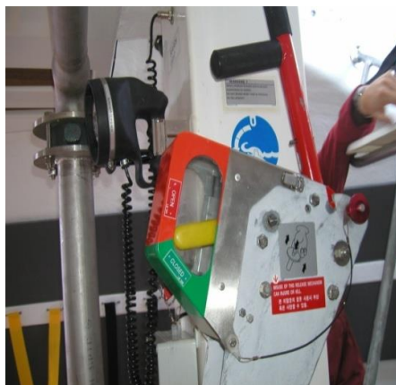
Figura 30: Palanca de liberación de los ganchos con criterio de colores [Figura propia]
