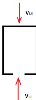
Figura 14. Representación de presiones ejercidas por el viento
