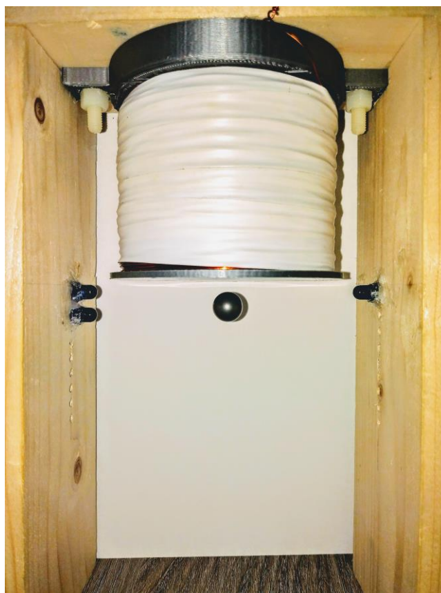
Figura 27: Fotografía de la bola levitando a 11 mm del electroimán
