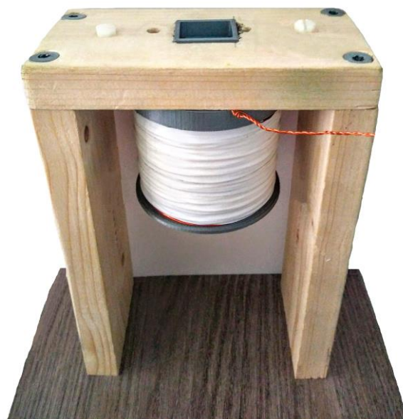
Figura 4: Estructura de madera con el electroimán
