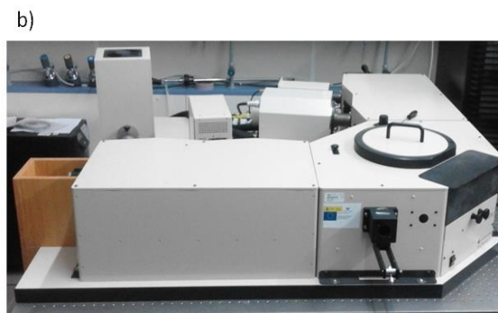
2.6. Irudia. a) Izpi bikoitzeko UV/VIS Varian Cary 4E espektrofotometroa b) Edinburgh Instruments (FLSP920 modelo) espektrofluorimetroa
