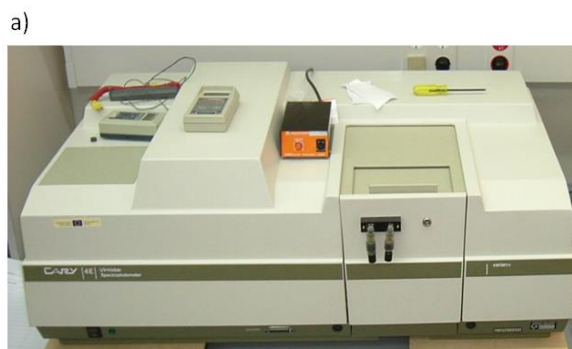
2.6. Irudia. a) Izpi bikoitzeko UV/VIS Varian Cary 4E espektrofotometroa b) Edinburgh Instruments (FLSP920 modelo) espektrofluorimetroa
