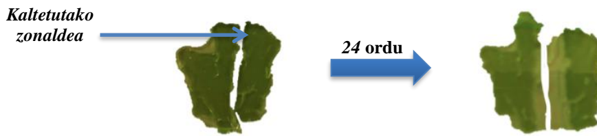
24. irudia: D sintesiko hidrogelen “self-healing” froga.
