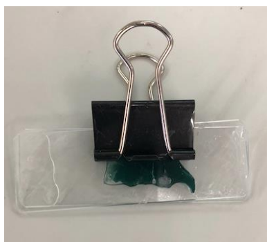
11. irudia: Kaltetutako hidrogelak lotuta mantentzeko muntaia.
