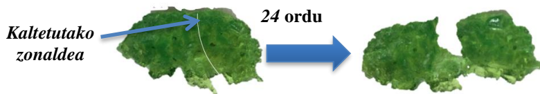
25. irudia: D sintesiko polimerizazio-denbora aldatzearen ondoriozko “self-healing” froga.
