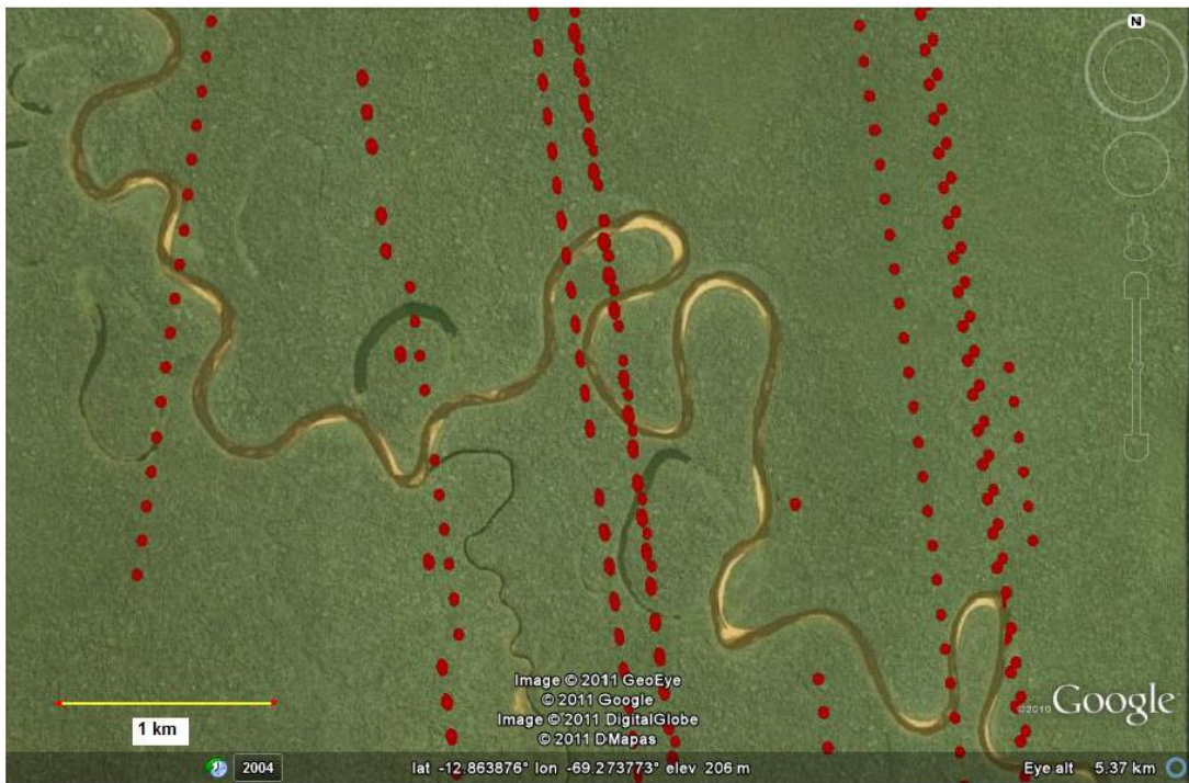
Figura 11 Huella de LiDAR satelital (Matti Maltamo et al., 2014)
