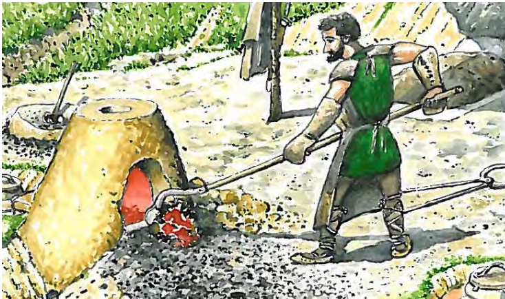
Figura 52. Extracción de la lupia de hierro o “agoa” al final del proceso de reducción en un horno vizcaíno por su parte superior, al que en este caso se ha añadido una hipotética chimenea. Dibujo: Fernando Hierro.
