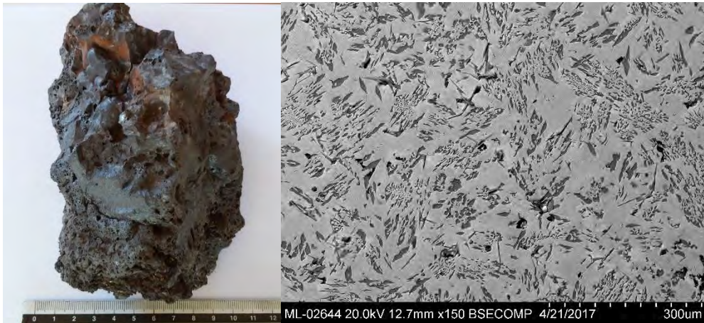
Figura 114 Izda: Escoria producida en el experimento de reducción. Dcha: Imagen general de la microestructura de la escoria. Los cristales poligonales grises son principalmente de magnetita y el material intersticial más oscuro es un vidrio rico en calcio y hierro. Imagen MEB, electrones retrodispersados.
