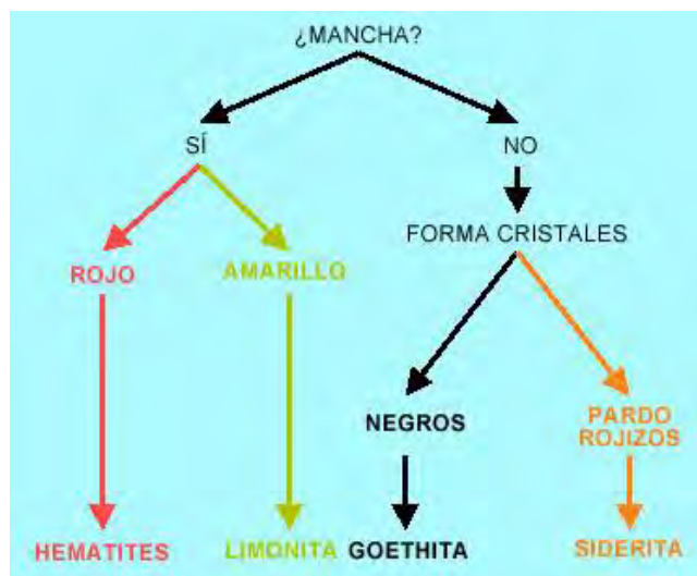
Figura 24. Cómo se pueden identificar los minerales de hierro de Bizkaia. Fuente: web.euskadi.eus
