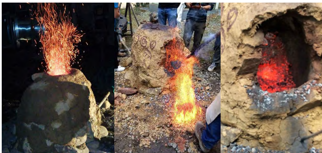
Figura 108. Experimentación en la UNED 2016, Centro asociado de Portugalete. Izda. Encendido nocturno del horno. Centro, Apertura del horno en la pared sobre la rampa interna. Dcha. lupia en el interior del horno.
