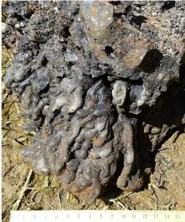
Figura 102. Escoria experimental de sangrado obtenida en el Pobal.
