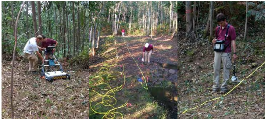
Figura 56. Georadar, tomografía eléctrica y magnetometría en el yacimiento de Callejaverde II (Muskiz).
