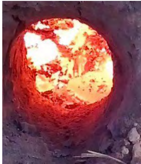
Figura 100: Interior del fondo de un horno experimental en funcionamiento desde el pequeño agujero de 5 cm que tiene en el fondo del crisol. Fuente: elaboración propia.
