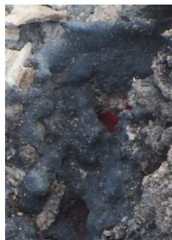
Figura 79. Sangrado producido en el interior del horno. Reducción experimental en el 2014 en el Museo de la Minería del País Vasco.
