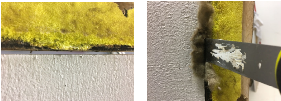
Figura 3.48: Tolerancia entre una muestra y el marco y sellado correcto de la misma.
