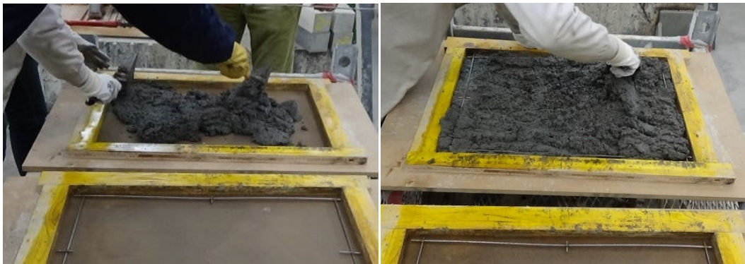
Figura 4.5: Elaboración de las probetas acústicas en las amasadas de noviembre de 2015 (bombeables).
