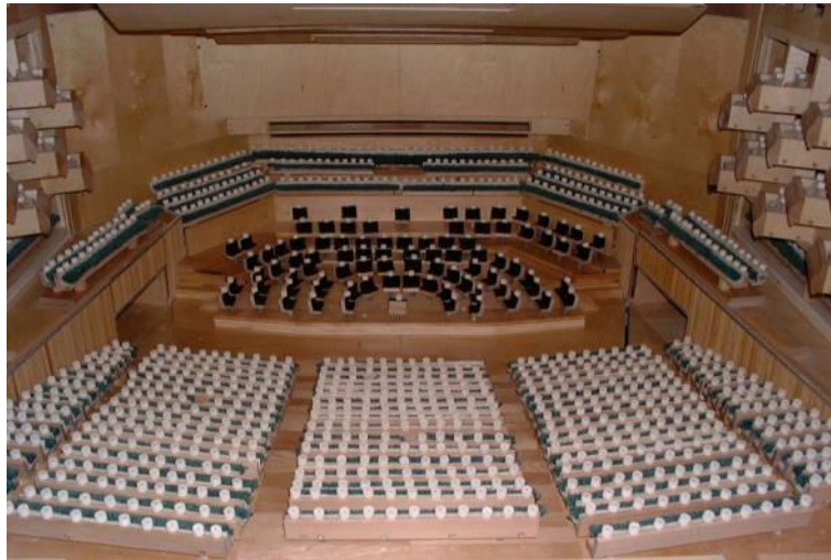
Figura 2.23: Modelo a escala de un auditorio. Fuente: Bridget Shield, Trevor Cox 1999/2000. University of Salford.
