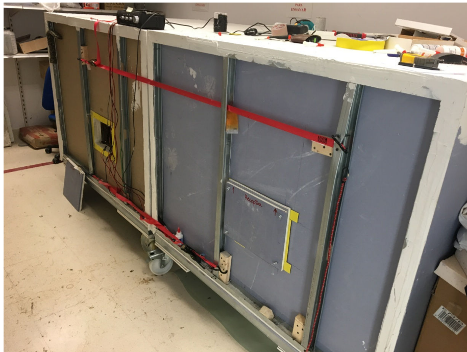
Figura 3.14: Cinchas colocadas en las cámaras asegurando la estanqueidad del conjunto.
