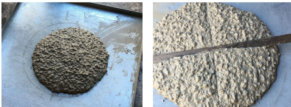
Figura 4.10: Aspecto de la masa fresca Ref-P durante el ensayo de escurrimiento.
