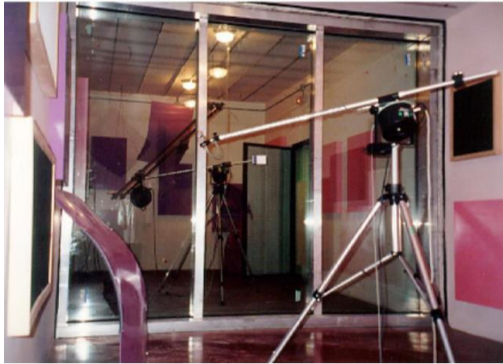
Fig.2.17: Medida de niveles de presión sonora en las cámaras dl LCCE del GV. La muestra (un muro cortina) permite ver al otro lado la cámara emisora, con la fuente acústica omnidireccional.
