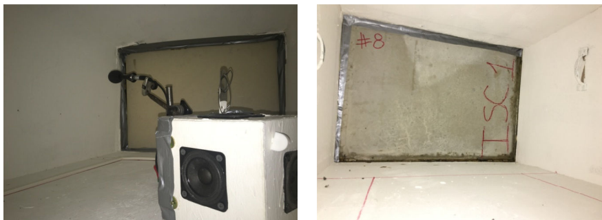
Figura 3.18: Cámaras emisora (izquierda, con una muestra de placas de yeso laminado) y receptora (con una muestra de hormigón colocada), durante la realización de ensayos.
