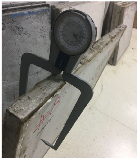
Figura 4.11: medida del espesor con un reloj comparador en diferentes puntos de una muestra.
