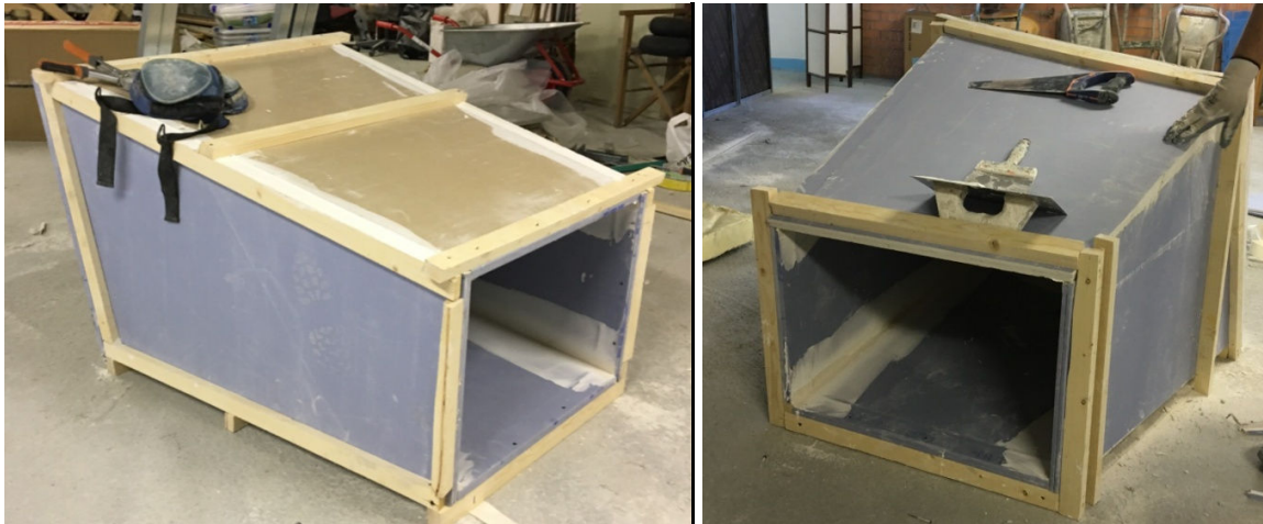
Figura 3.5: Cámaras receptora y emisora durante su construcción.
