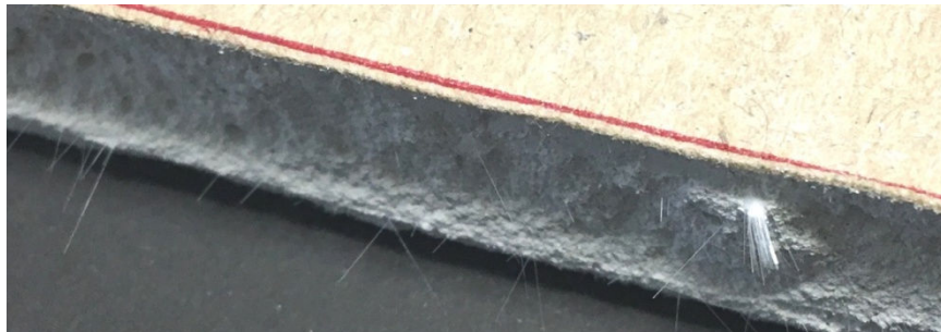
Figura 5.3: Sección de una de las placas de yeso laminado, donde se aprecia la presencia de fibras sintéticas.
