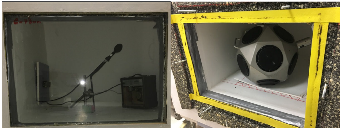
Figura 3.20: Pruebas iniciales utilizando una fuente unidireccional y tamaño relativo de una fuente comercial respecto a las propias cámaras.
