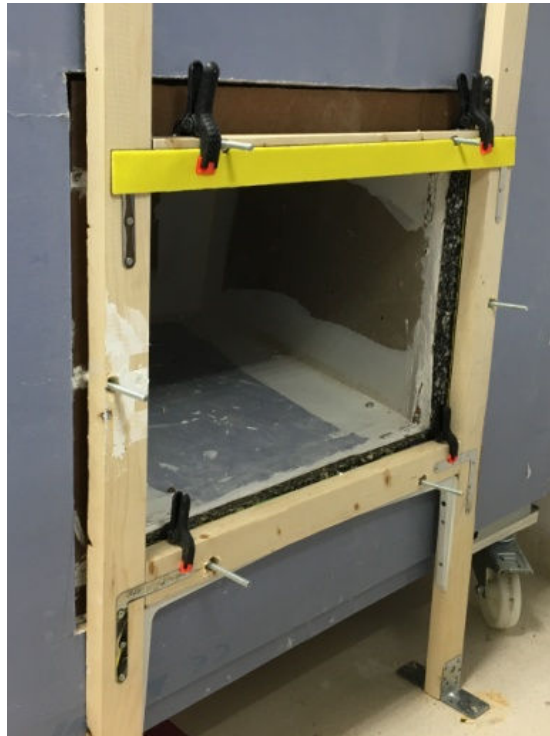
Figura 3.12: Construcción del marco portamuestras.
