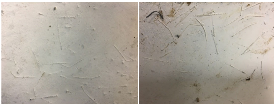
Figura 4.7: Probetas acústicas con fibras sintéticas y metálicas.
