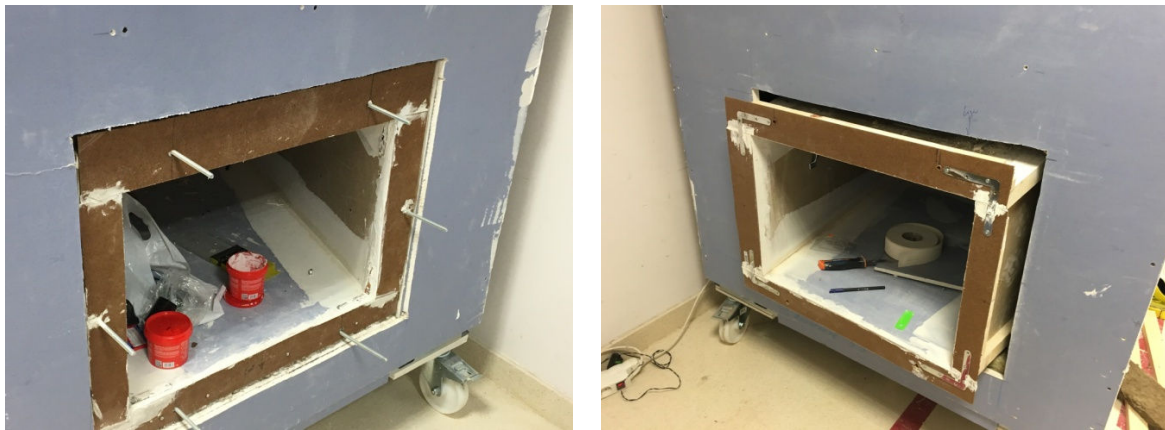
Figura 3.9: Borde de madera colocado en ambas cámaras.
