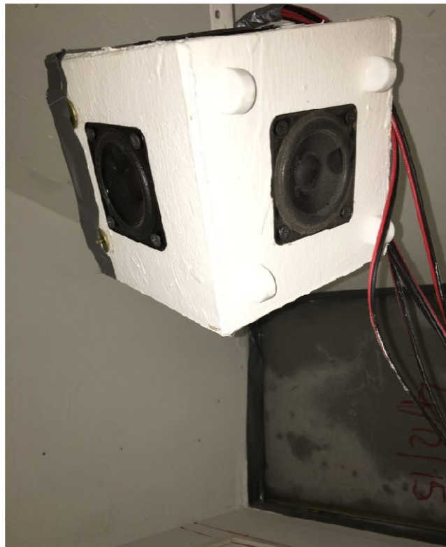
Figura 3.22: Fuente omnidireccional colgada del techo de la cámara emisora.
