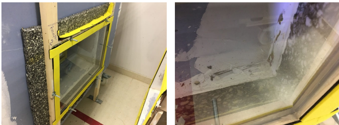
Figura 3.10: Sellado elástico con cámara emisora.
