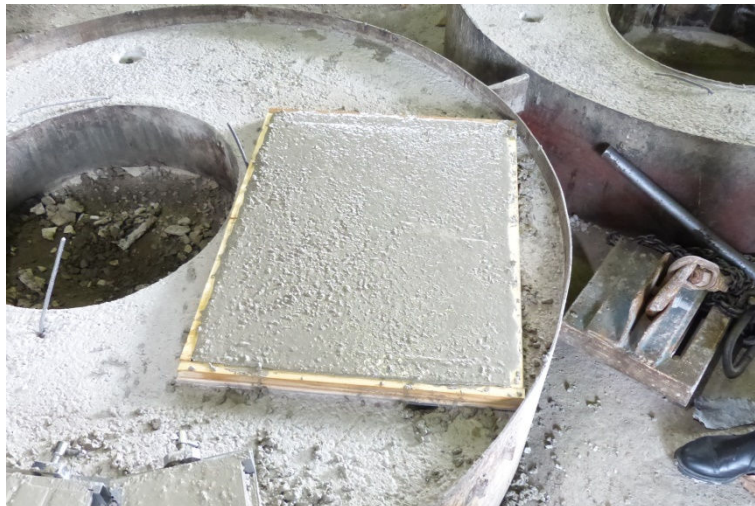
Figura 4.2: Probeta de hormigón aligerado con serrín, durante su fabricación.
