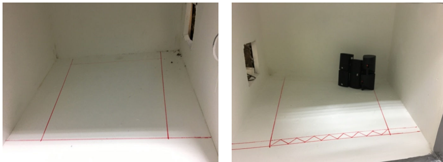
Figura 3.16: Interior pintado. Las líneas rojas marcan los límites de colocación de posiciones de micro.
