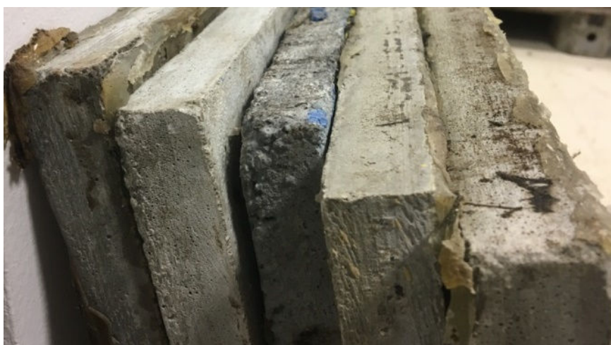
Figura 4.13: Diferentes muestras con diferencias en el espesor real.
