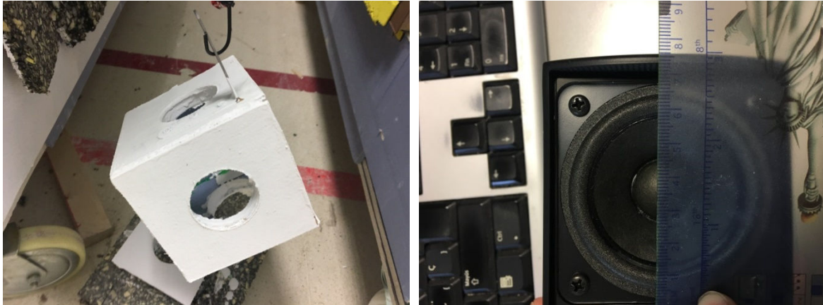
Figura 3.21: Construcción de una fuente específica con arreglo al empleo de 6 altavoces de 2,5"
