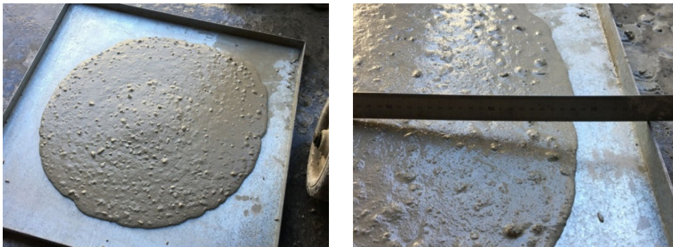
Figura 4.9: Aspecto de la masa fresca Ref-SC durante el ensayo de escurrimiento.
