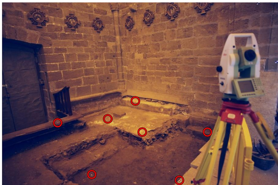
Fig. 9.- Medida de los puntos de apoyo para el modelado fotogramétrico (las dianas visibles en la imagen se han resaltado con un círculo rojo).
