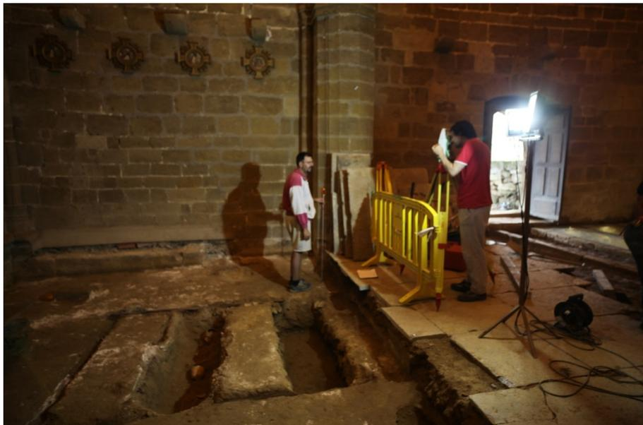
Fig. 8.- Documentación de las unidades estratigráficas (UE) mediante medidas con estación total.
