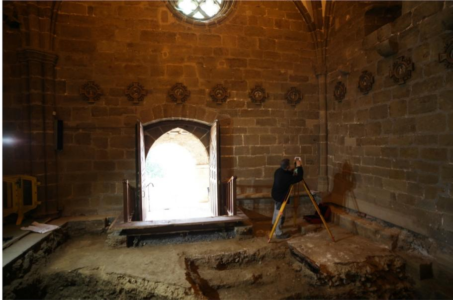
Fig. 7.- Estacionamiento en el interior de la iglesia tomando como referencia las dianas de la red topográfica.
