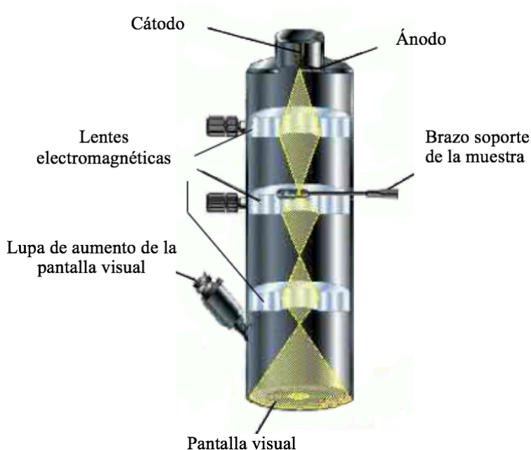
Imagen 10. Partes de un microscopio electrónico de transmisión.
