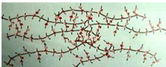
11. Figura. Disposición macromolecular de los termoplásticos.
