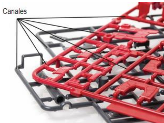
34. Figura. Producto a la venta sin haber retirado la estructura de canales para un mejor manejo en el embalaje de las piezas.
