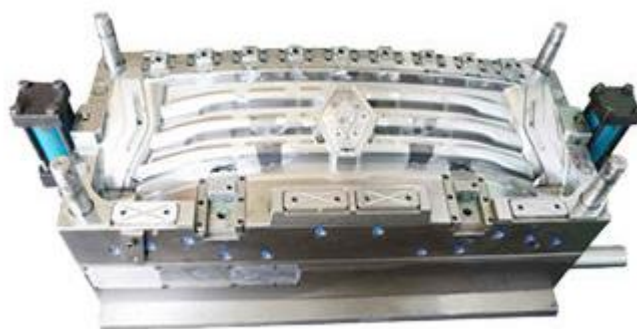
19. Figura. Molde de cavidad única de una rejilla frontal de Renault.
