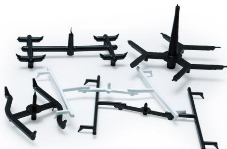
26. Figura. Desechos obtenidos debido a la colada en frío.
