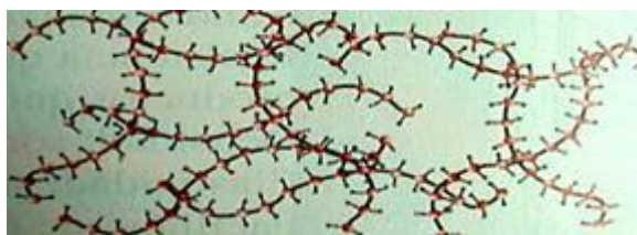
12. Figura. Disposición macromolecular de los termoestables.
