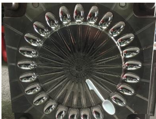
20. Figura. Molde multicavidad para la fabricación de cucharas de plástico.
