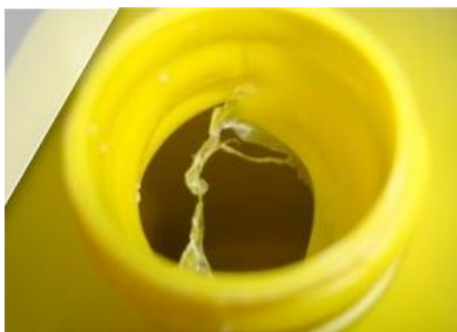
71. Figura. Rebaba en pieza moldeada.
