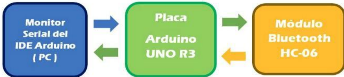
Figura 35: Diagrama de envío y recepción de datos entre módulo bluetooth y Arduino
